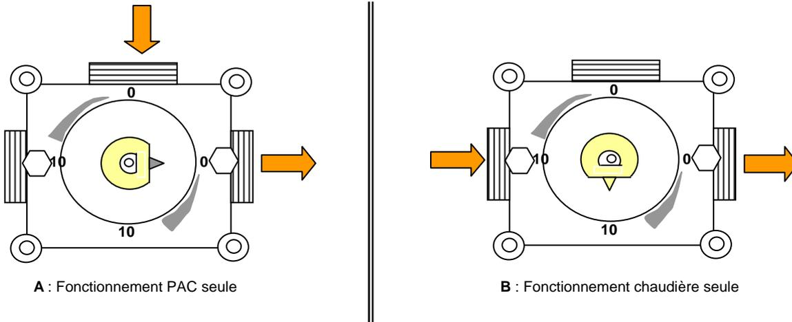
**Raccordement Hydraulique - Schéma de principe**
