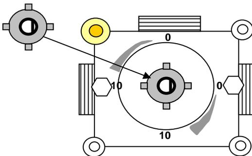
**4) Prendre le servomoteur, débrayer le moteur si besoin et positionner la poignée suivant le schéma ci dessous puis monter le servomoteur sur la vanne**
